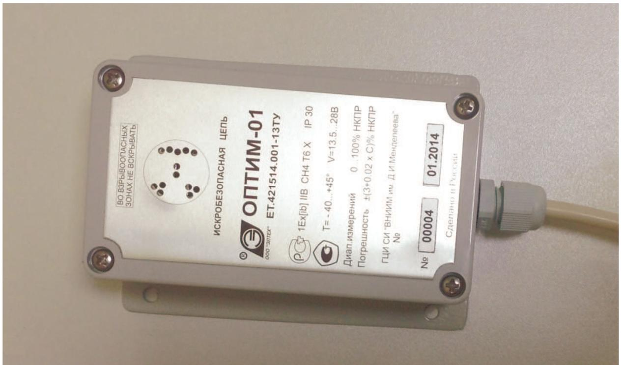
Конструктивно преобразователь выполнен в виде прямоугольного корпуса с крышкой, на боковой грани которого расположен гермоввод кабеля для подключения внешних цепей. Сенсор концентрации газа расположен под крышкой корпуса, имеющей пробозаборные отверстия и противопылевой фильтр.
