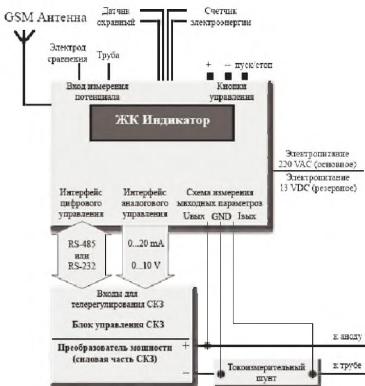
Рис. 4. Схема подключения ТМ к СКЗ
